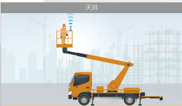
建機 特殊車両 建機・高所作業車から天井構造物までの距離検知 過酷な環境（粉塵）での検知・距離検知
