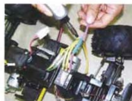
熱収縮チューブ作業
