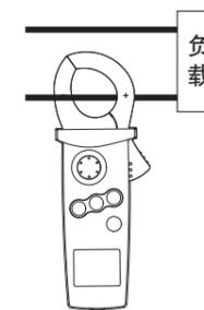
在电流探头中央夹入一根电线。
