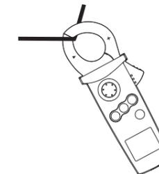
用电流钳头拽扯被测导线
