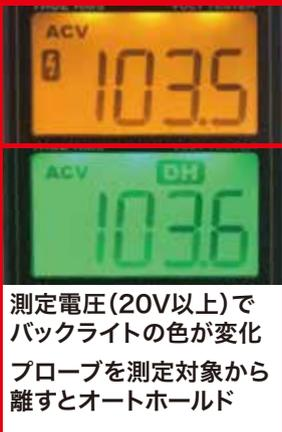
測定電圧(20V以上)でバックライトの色が変化
