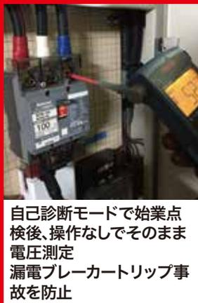
自己診断モードで始業点検後、操作なしでそのまま電圧測定
